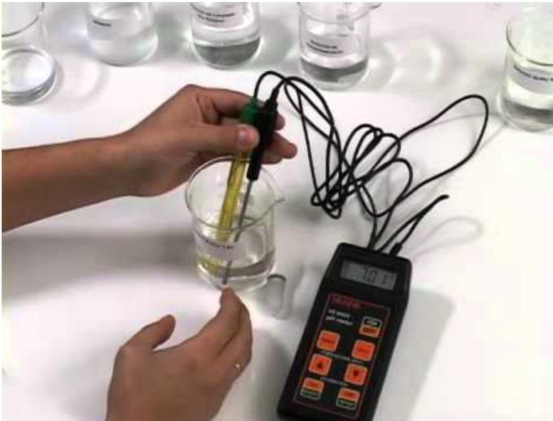
**Un pHmetro è uno strumento consistente in una vasca con 2 elettrodi uno dei quali immerso in una soluzione tampone usata come riferimento.**
